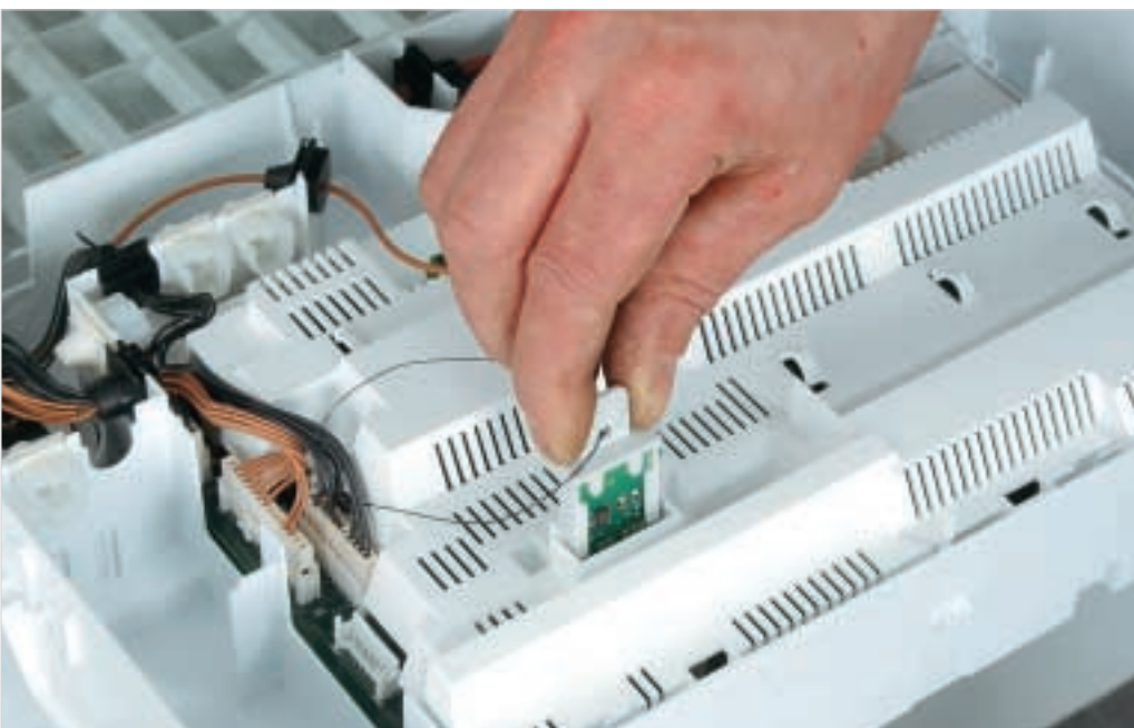
Wszystkie kotły wiszące posiadają teraz wtyczkę kodową
